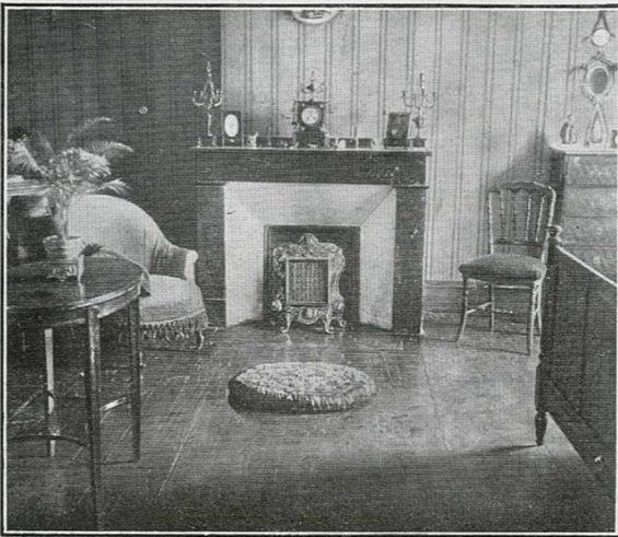
Fig. 1. — Chambre de l'Hôtel Régina, à Saint-Girons, chauffée par un radiateur électrique placé devant la cheminée.
