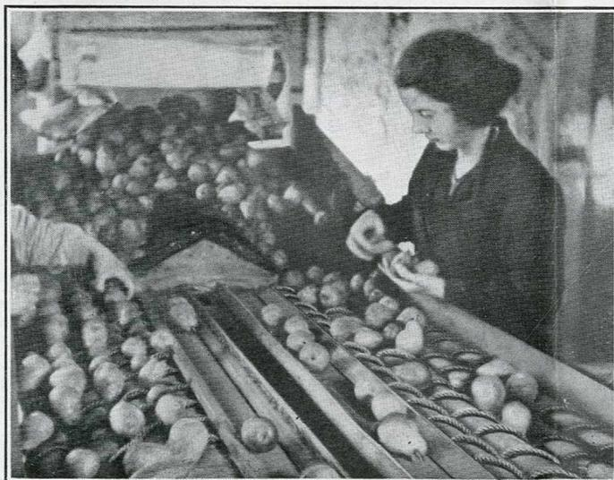
Fig. 2. — Triage des fruits. Les fruits sont versés sur une trémie capitonnée; ils tombent sur la table de triage où des vis d'Archimède les amènent devant les ouvrières. Les bons fruits sont placés sur les tapis roulants au centre de la table.
